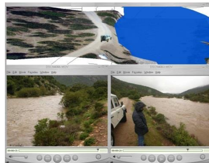
Simulation 3D Flood (temps de retour de 5 ans) et inondation naturelle de Décembre 2004 (Auteur: Enas)
