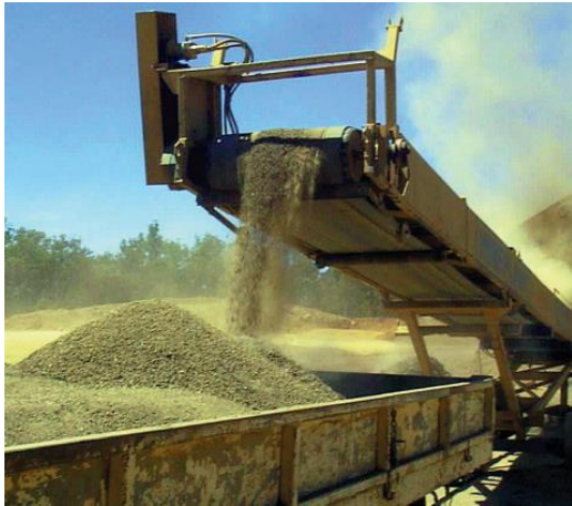
Lo strato superficiale del terreno è stato setacciato per ottenere una miscela ricca di sementi e viene utilizzato per massimizzare la crescita nelle aree ripristinate (Autore: Alcoa World Alumina in Australia ©)
